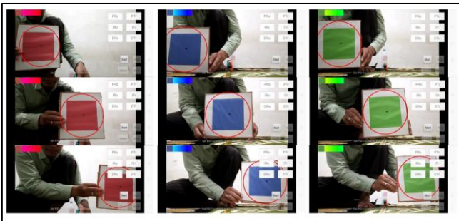
Gambar 6. Pengujian Deteksi Objek Berjarak 50 cm dengan Tiga Warna Berbeda
