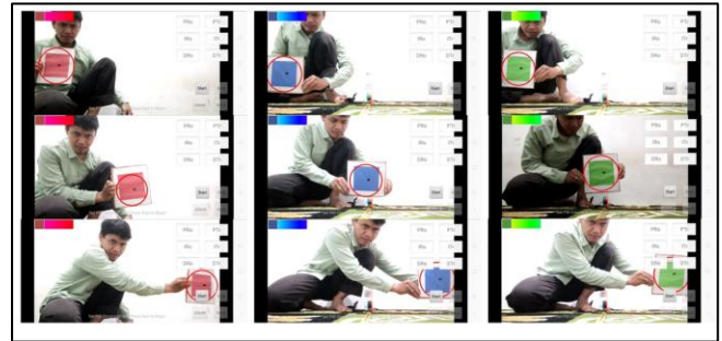
Gambar 7. Pengujian Deteksi Objek Berjarak 100 cm dengan Tiga Warna Berbeda
