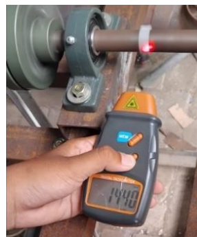
Gambar 5. Pengukuran kecepatan putar poros
