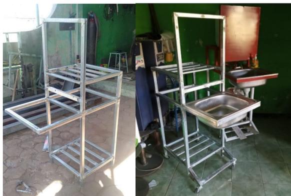
**Gambar 7.** Proses fabrikasi rangka wastafel tanpa sentuh
