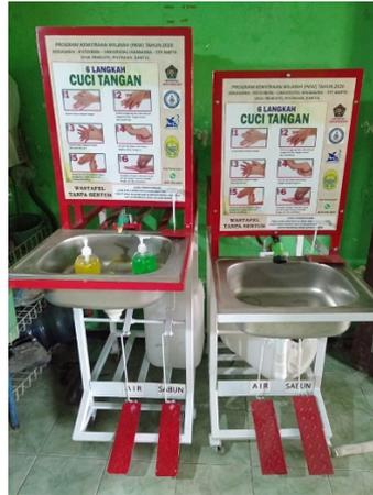
Gambar 8. Hasil fabrikasi wastafel tanpa sentuh yang siap untuk digunakan
