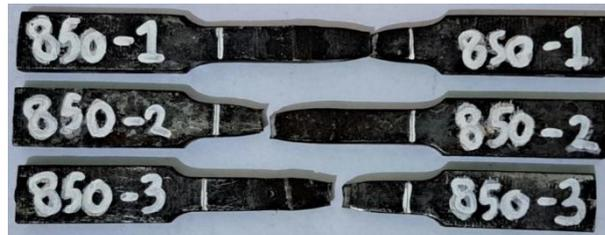
Gambar 9. Spesimen Uji Tarik
