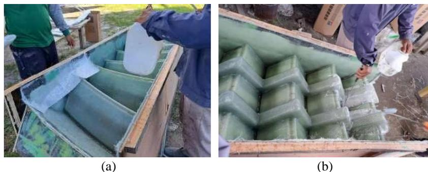
**Gambar 4.** Proses Laminasi Tangga (a) Bagian Atas dan Dinding Tangga dan (b) Bagian Bawah dan Gading Tangga
