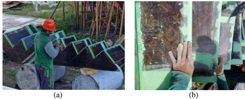
**Gambar 3.** (a) Pendempulan Cetakan dan (b) Pengamplasan Cetakan
