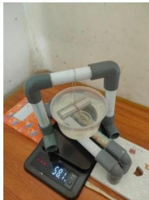
Gambar 7. Pengambilan massa spesimen didalam air
