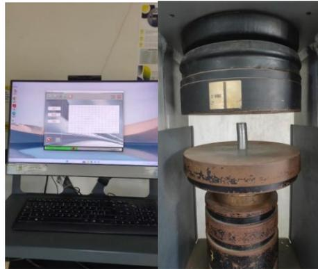
Gambar 10. Pengujian kekuatan tekan
