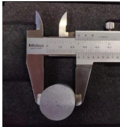
**Gambar 9.** Pengukuran diameter potongan spesimen untuk pengamatan porositas
