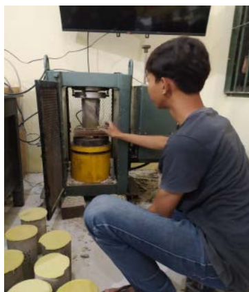
Gambar 8. Pengujian Kuat Tekan Silinder
